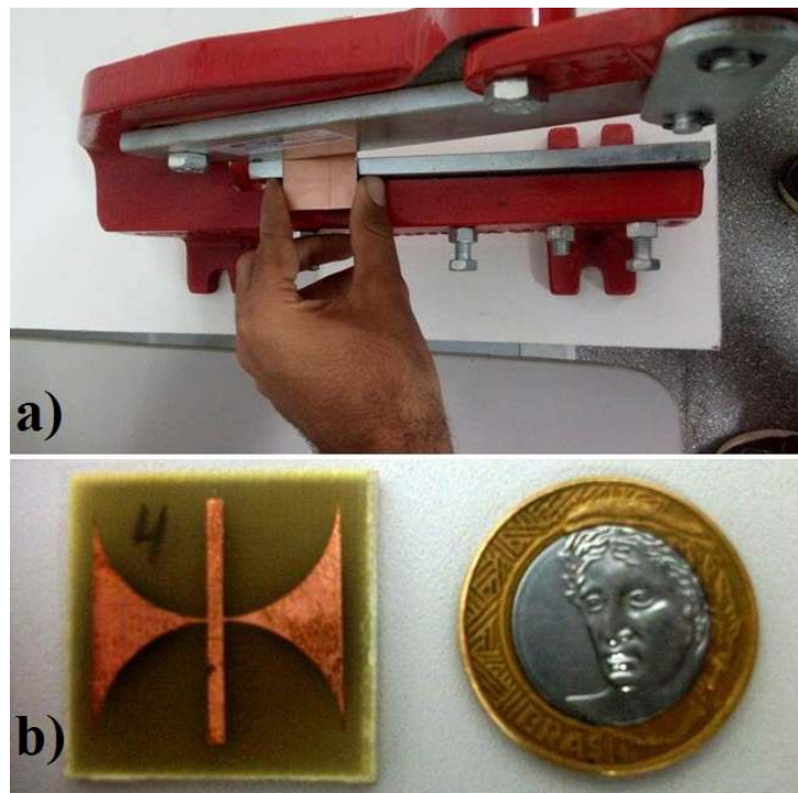
Figura 3 – Metodologia empregada na construção do filtro de microfita: (a) corte da placa de fibra de vidro e (b) antena construída após a fase de corrosão em solução de perclorato de ferro.
