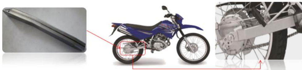
Figura 6 – Identificação do garfo traseiro
